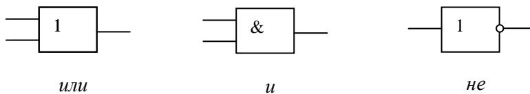
Сложные логические (принципиальные, функциональные) схемы можно конструировать из логических элементов, используя основные понятия и формулы булевой алгебры. Обозначим входные сигналы буквами, сформируем логическую формулу и максимально упростим ее. Затем конструируем соответствующую схему, заменяя каждую логическую операцию соответствующим логическим элементом.
