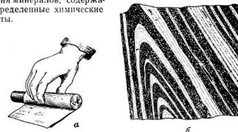
Рис. 41. Получение отпечатка с керна а — закатка керна в фотобумагу; б — развертка отпечатка керна (после проявления)
